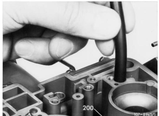
6 Einspritzbohrungen (Pfeile) der Beschleunigungspumpe mit Preßluft durchblasen und auf Durchgang prüfen (Einspritzbohrungen evtl. mit einem Bohrer 0,4 mm reinigen).
