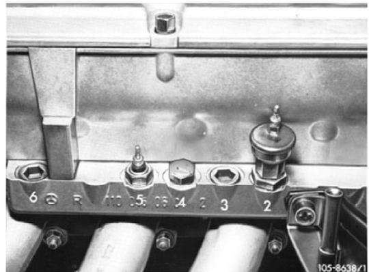
**Meßfühlerkasten Vergaser-Motor mit Klimaanlage**
