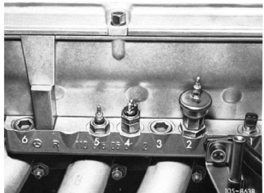
**Meßfühlerkasten Einspritz-Motor mit Klimaanlage**
