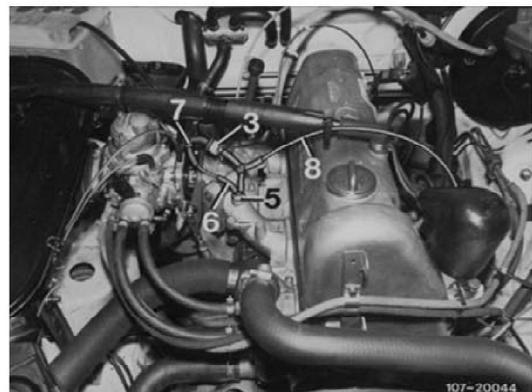
Einbauanordnung Typ 115 bzw. 123, wenn am Saugrohr keine freie Bohrung für das Thermoventil zur Verfügung steht.
